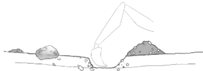
År 1 Skovrejsning : udlægning af sten og gravning af hul-høj strukturer
